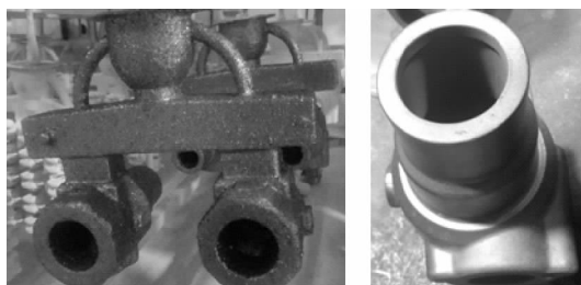
(a) 过渡层撒鳞片石墨砂 (b) 阀体表面质量
